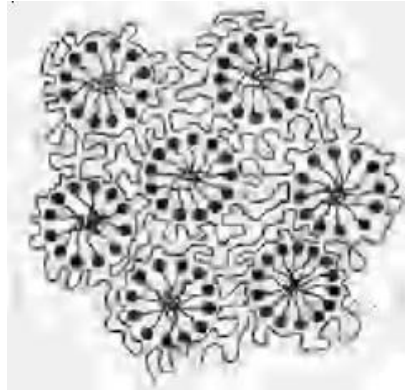
Figura 147 Interacción entre surfactantes y polímeros en la zona de transición. (Tharwat F., 2005)
