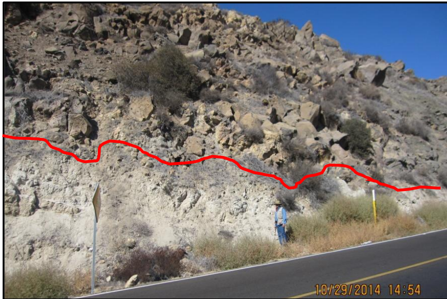
Figura 2.10 Contacto discordante entre las areniscas del miembro superior de la Formación Rosario y basaltos en bloques de la Formación Rosarito Beach.
