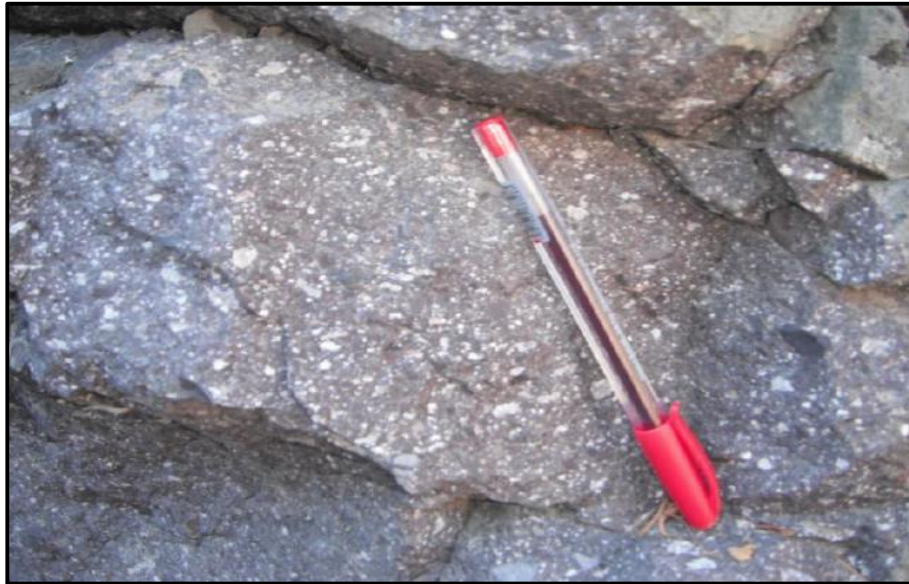
Figura 2.4 Textura fanerítica de la Formación Alisitos.
