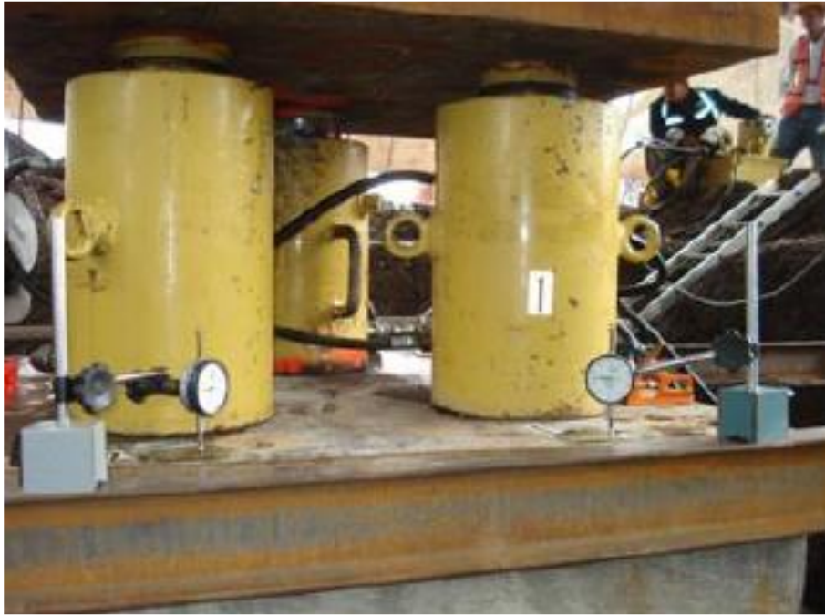
Figura 5.18 Pruebas de carga para compresión en racks de tuberías.
