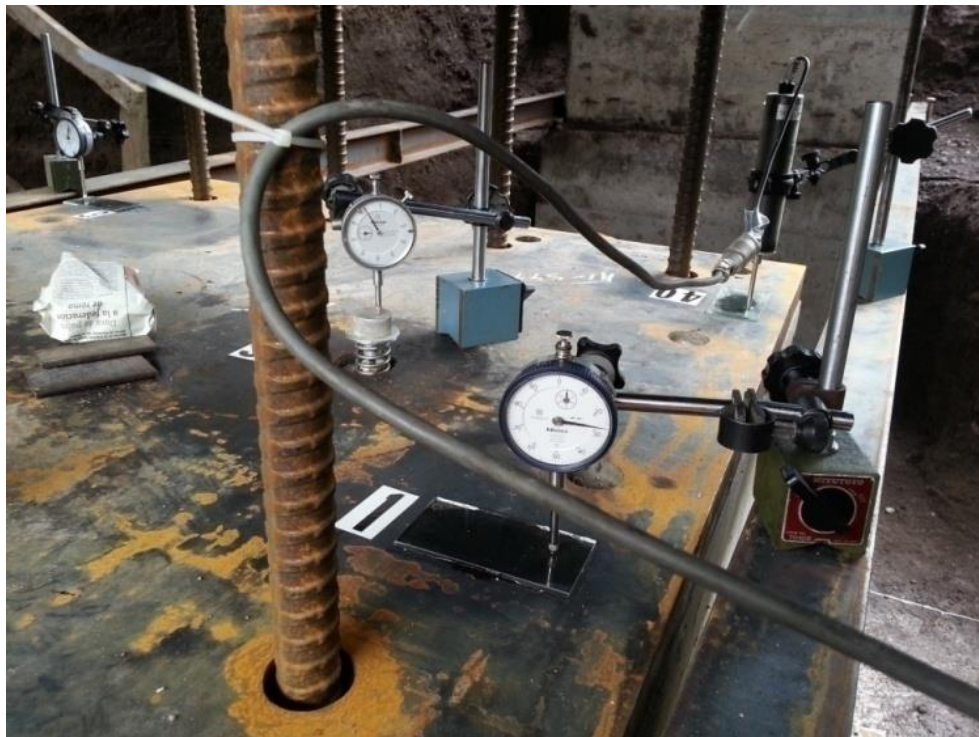
Figura 5.17 Micrómetros para medir las deformaciones.
