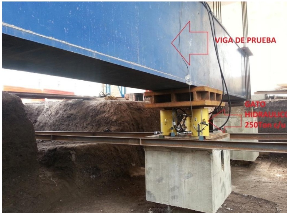
Figura 5.2 Prueba de carga a compresión en racks de servicios.
