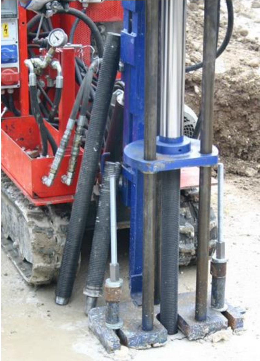
Figura 4.4 Máquina barrenadora para micropilotes (hasta 12 m de profundidad y 0.15 m de diámetro).
