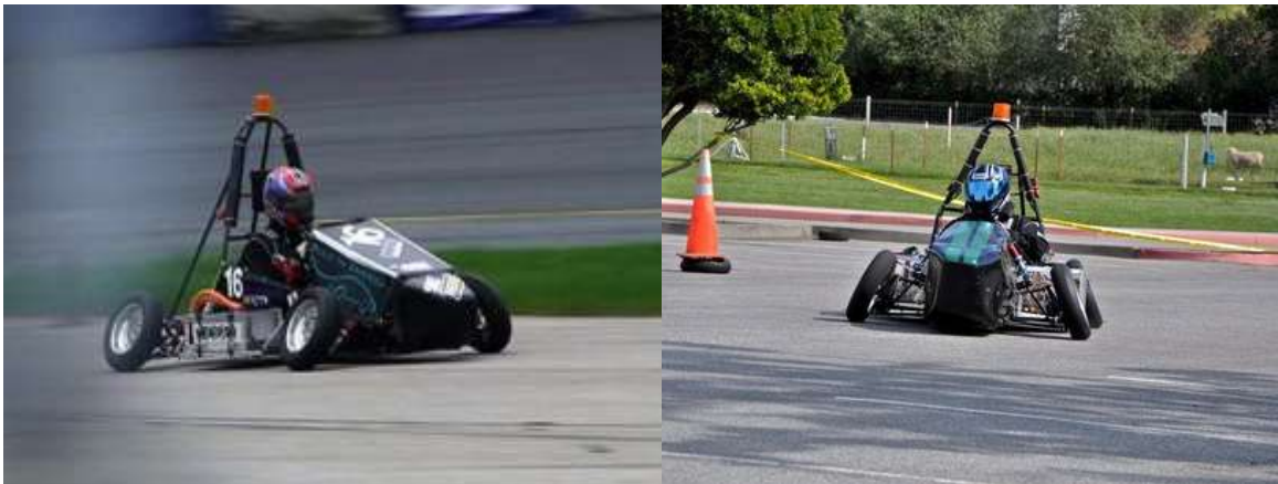
Ilustración 31- El Cal Poly Formula Hybrid 2009 hizo uso de valores extremos de camber en neumáticos delgados para compensar la sensibilidad a la carga
