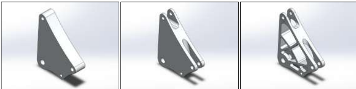
Ilustración 44 - Proceso de remoción de material
