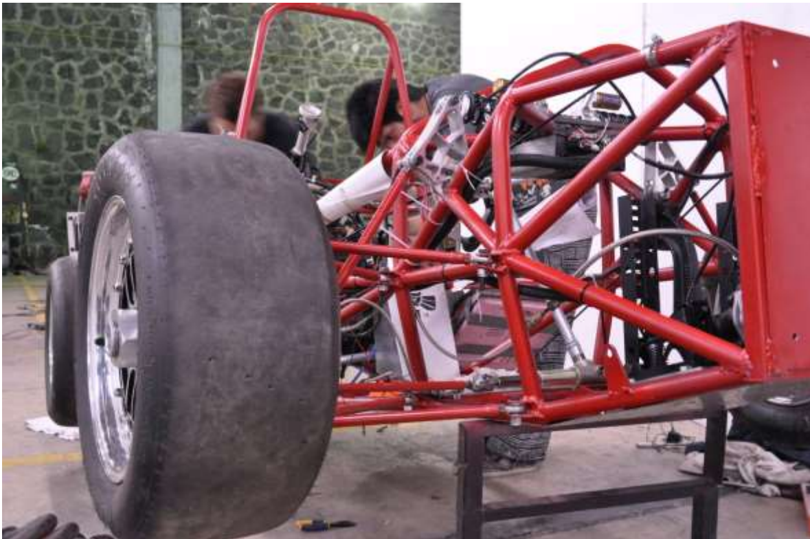
Ilustración 51– Sistema de suspensión utilizado en el UM-513. Al fondo miembros del equipo realizando ajustes
