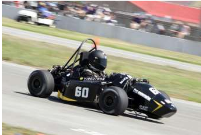
Ilustración 24– Vehículo ganador de FSAE West 2011, carente de paquete aerodinámico
