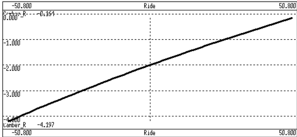
Ilustración 37 - Variación del camber con respecto al movimiento vertical de la suspensión
