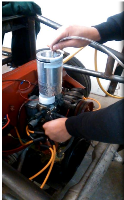
Figura 3.31. Toma de presiones en la entrada del mezclador de gases.
