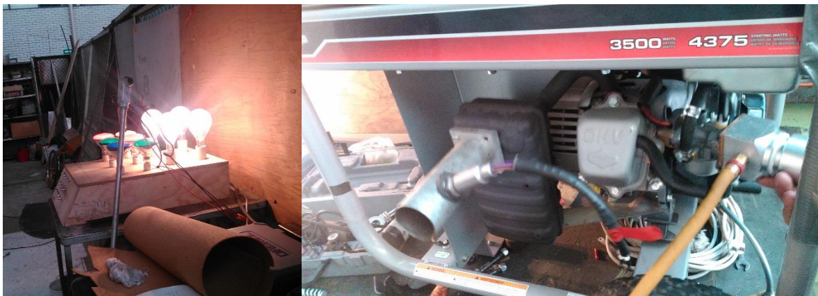
Figura 3.28. Prueba del mezclador de gases del motogenerador.
