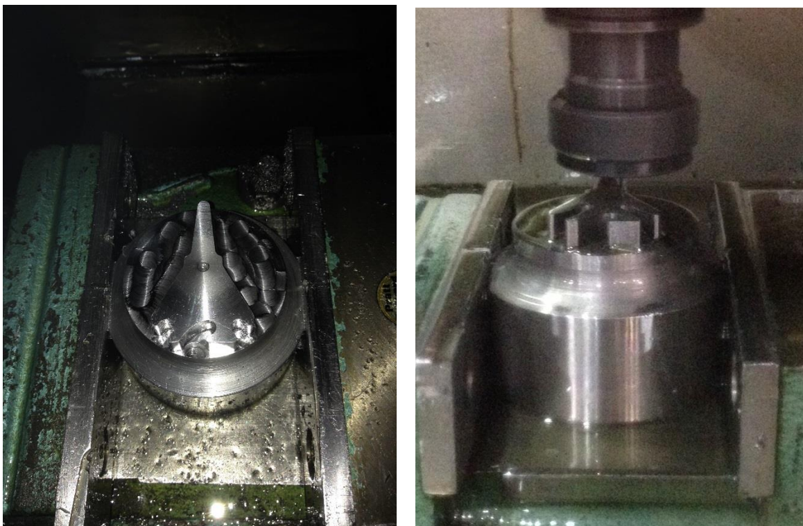
Figura 4.5 Finalización de la geometría del punzón en la máquina CNC
