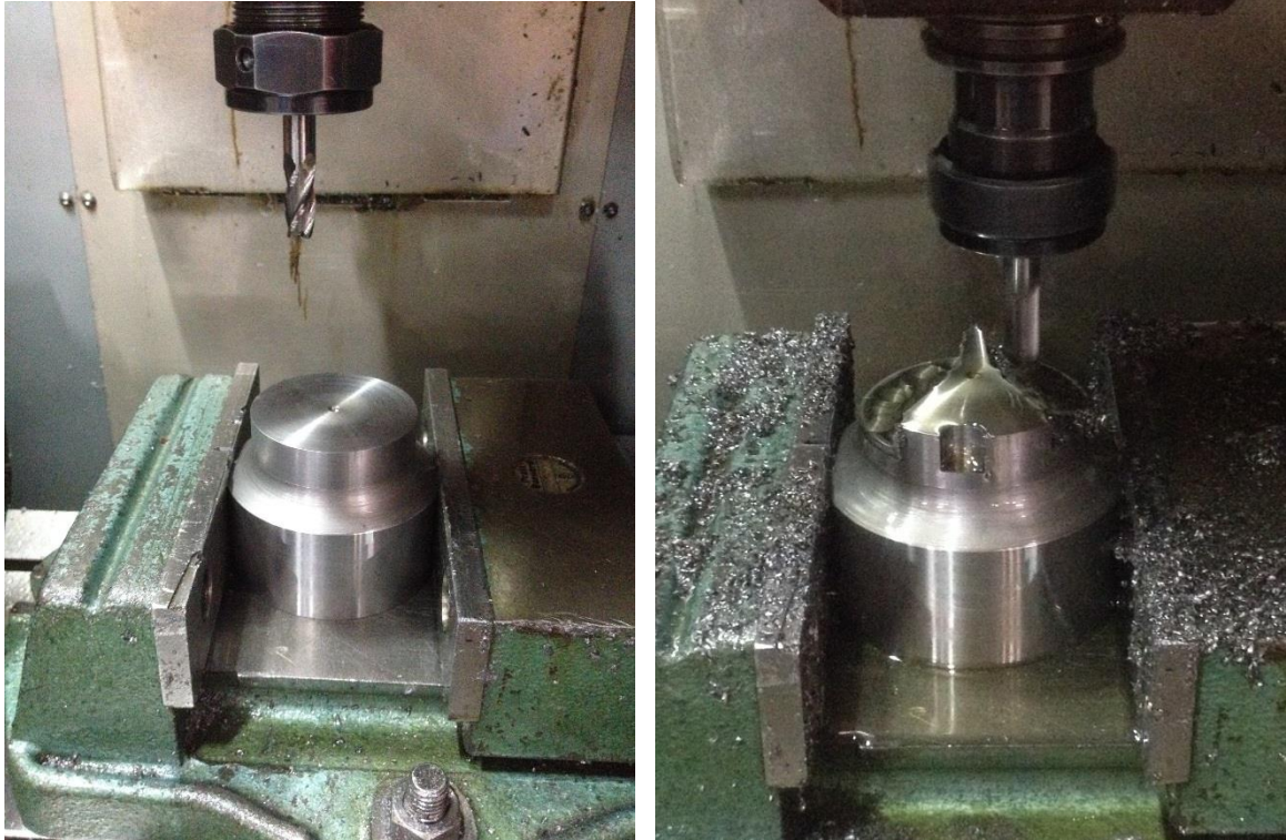
Figura 4.4 Maquinado del punzón en la máquina CNC
