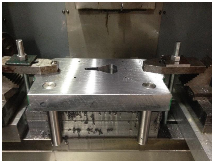
Figura 4.6 Maquinado de la cavidad de expulsión
