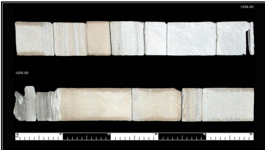
Figura 2.6 Muestra de la Megasecuencia Media, segmento de 1255 m a 1256 m de profundidad perteneciente al núcleo 3 del pozo Madrina-874, con arenisca gris a gris pardo, de grano fino a medio, con cuarzo, en matriz arcillo-calcárea, consolidada, con intercalaciones de lutita gris verdosa, deleznable, ligeramente arenosa y calcárea (CNH-UNAM, 2012) 23 .
