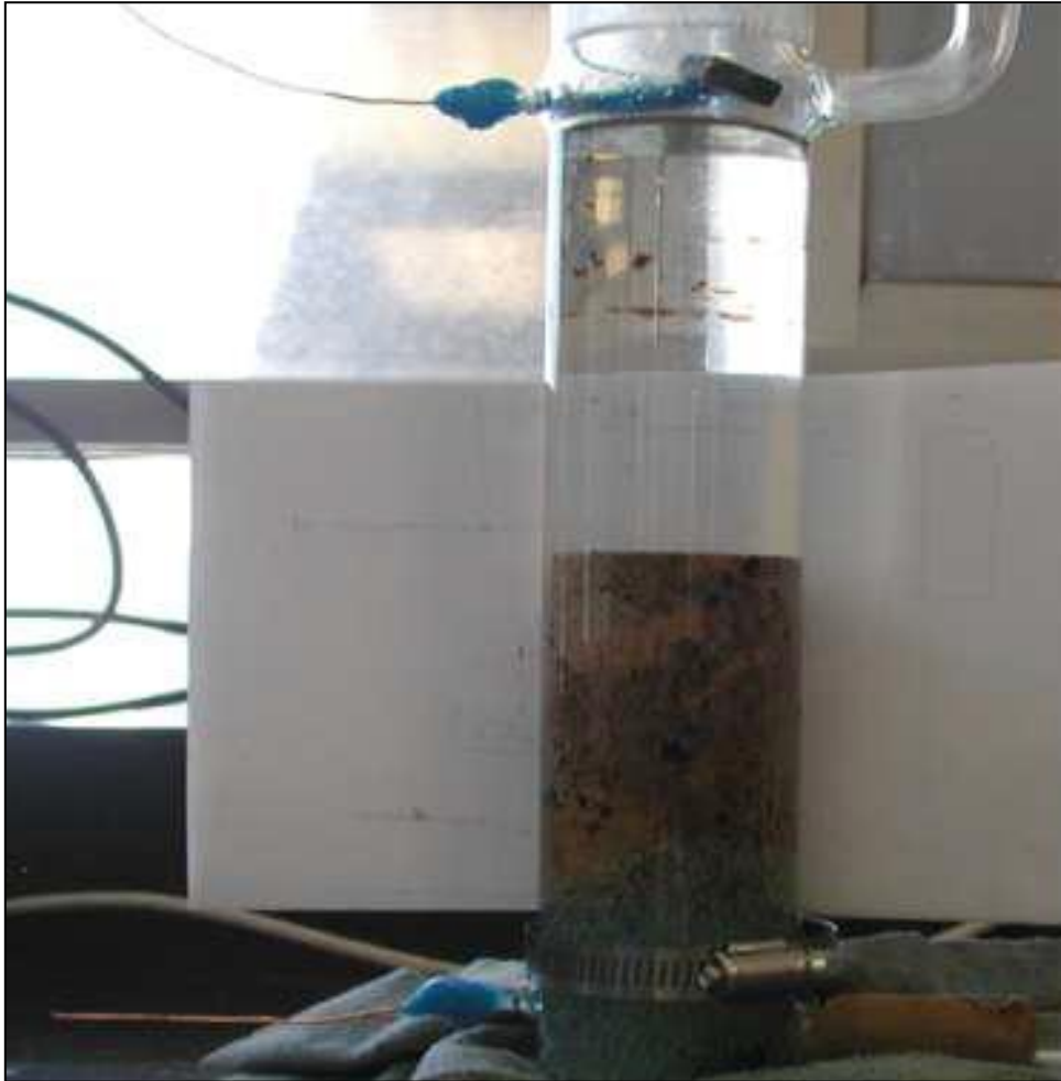
Figura 4.5 Estudio experimental del calentamiento por efecto joule en un medio fracturado
