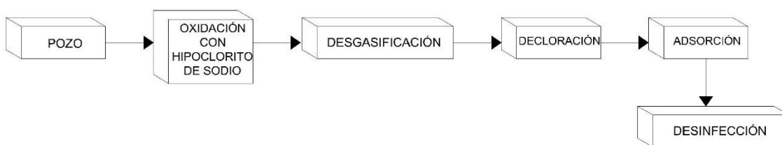
Figura 3.101 Tren de tratamiento Cerrillos 2
