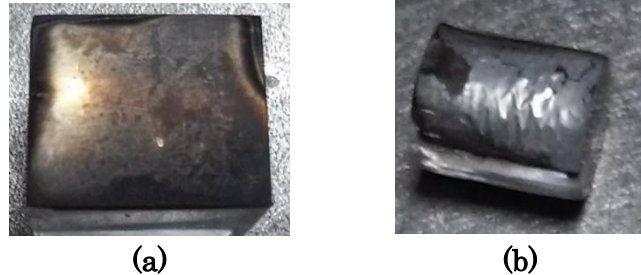
Figura 4.2. Comparativa entre depósitos de aluminio de (a) buena calidad y (b) mala calidad.
