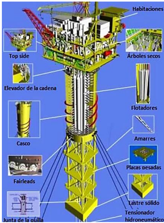
Figura 1.33 Componentes de la Boya Spar
