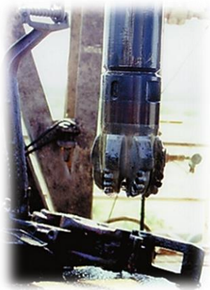
Figura 3.10 Barrena de 8 ½” PDC
