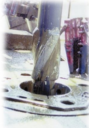
Figura 3.11 Estabilizadores de 6 ½” x 8 3/8”
