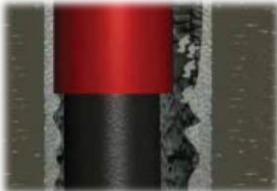
Figura 2.38 La tubería de revestimiento es forzada en la pared del pozo a medida que avanza dentro del agujero.
