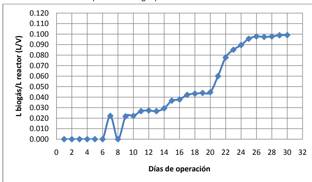
Figura IV.14: Producción diaria específica de biogás para un sustrato de las características de la carga C
