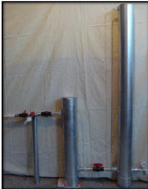
El tubo de 0.66m posee en su parte superior una entrada/salida de gas en "T", permitiendo el ingreso del biogás producido por el reactor y la salida de éste para su almacenamiento y empleo. La interconexión entre los tubos se realiza en la parte inferior mediante un tubo de PVC de ½" con una llave de "bola" intercalada para permitir o inhibir el flujo de agua entre ellos. El tubo de 1.30m,
