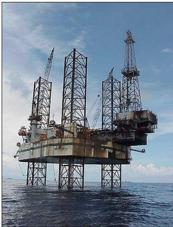
Figura 1.8. Equipo Autoelevable (Jack-up) en operación. (PEMEX-PEP)
