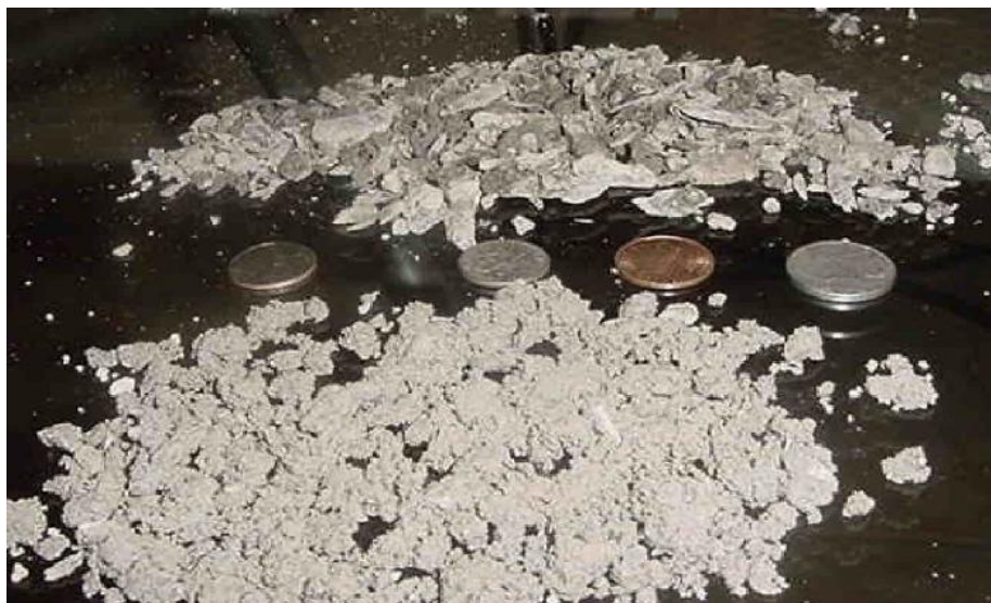
Figura 2.15. Tipos de recortes de perforación. Los tamaños de recortes son más finos con la perforación con TR (abajo) que los recortes con la perforación convencional (arriba). (ConocoPhillips).
