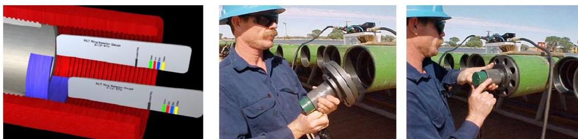
Figura 4.24. La selección del anillo se hace simplemente con una herramienta que se inserta en el extremo del acoplamiento (izquierda). La instalación es rápida y fácil con una sencilla herramienta de accionamiento hidráulico portátil. (Boletín TESCO, 65000).
