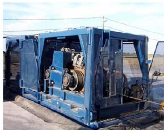
Figura 4.20. Unidad de línea de acero para las operaciones de recuperación del BHA. Ésta integrado por tres componentes, los cuales son: en la parte frontal se encuentra la unidad de tracción, en la parte posterior se cuenta con un carrete con 20,000 ft de línea de 5/8", al lado se aloja la cabina de control. (SPE-99248).
