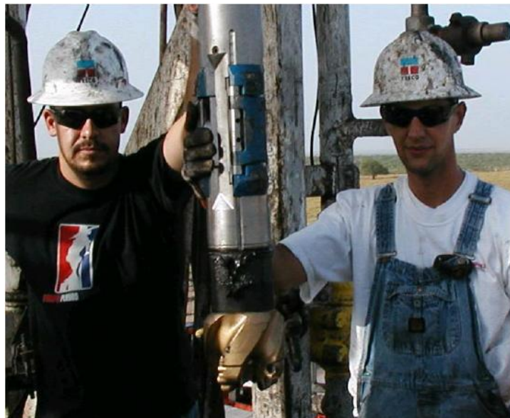
Figura 5.9. Personal de perforación preparando la corrida de un sistema RSS y barrena PDC en un BHA de perforación direccional con TR (SPE-92195).
