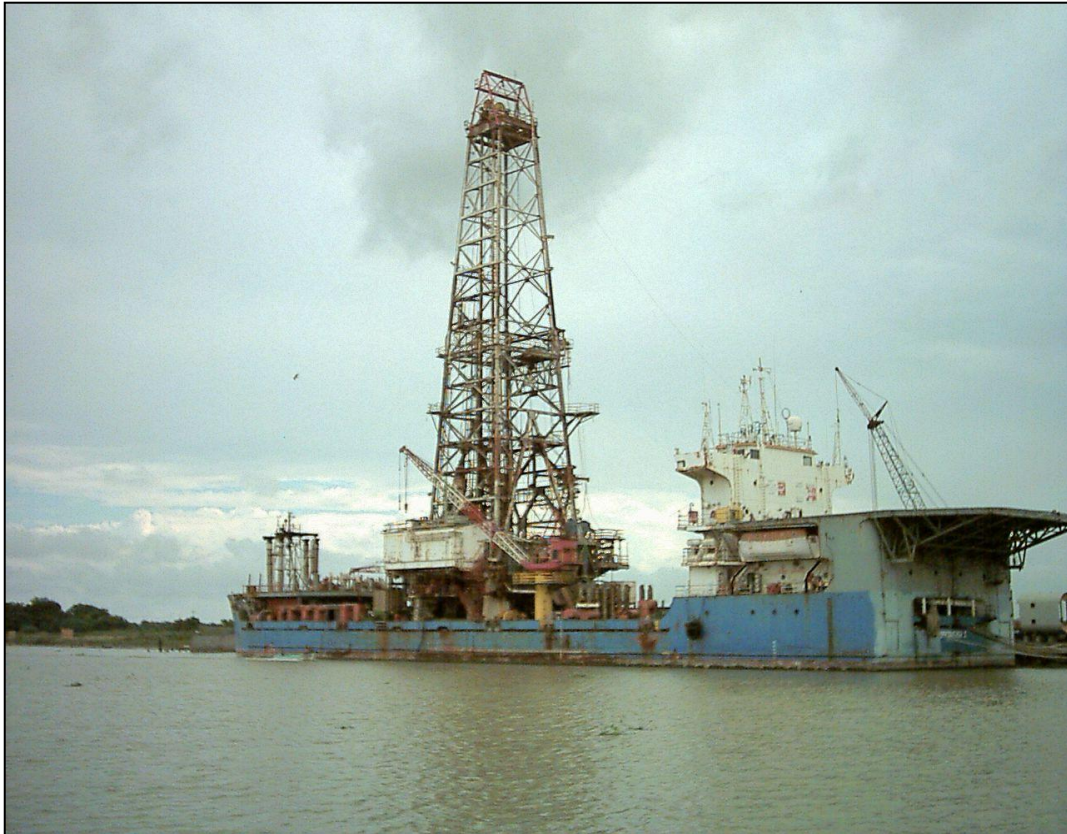
Figura 1.10. Barco Perforador con propulsión propia. (PEMEX-UPMP)
