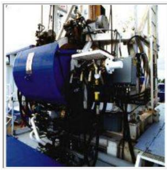
Figura 4.11. Integración del Malacate y Mástil (TESCO).
