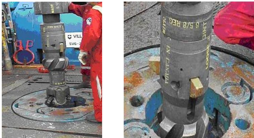
Figura 4.31. Ampliador y barrena piloto extendidos debajo de la zapata de TR (Izquierda), ampliador con brazos retráctiles activados (Derecha). (OTC-17141)
