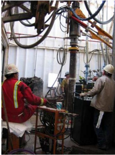
Figura 4.13. Perforador manipulando el Top Drive desde el panel de control (SPE-96810).
