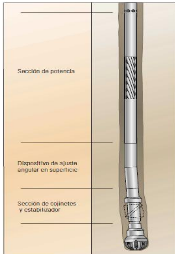
Figura 5.2. BHA direccional. El PowerPak es un dispositivo direccional simple pero resistente, compuesto por una sección generadora de potencia, un dispositivo de ajuste angular en superficie, un estabilizador y la barrena de perforación. (Oilfield Review, 2000).
