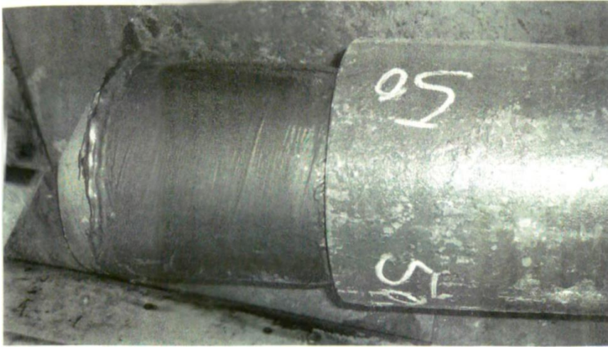
Figura 3.1 Mandril usado para deformar permanentemente tubería sólida expandible
