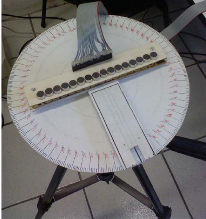
Figura C.6 Arreglo de micrófonos sobre el disco transportador.
