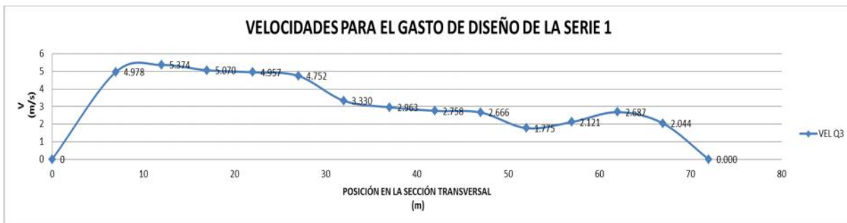
Ilustración 3.37 Gráfica de velocidades para el gasto de diseño 4,795 \text{ m}^3/\text{s}
