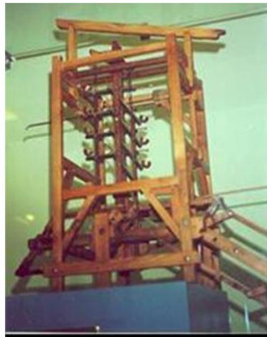
Ilustración 3.2 Replica del modelo reducido del artificio hecho por Juanelo Turriano en el siglo XVI
