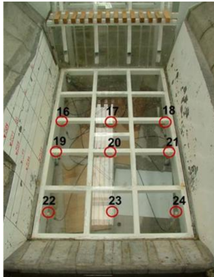
Ilustración 3.56. Distribución de piezómetros en el tanque amortiguador.
