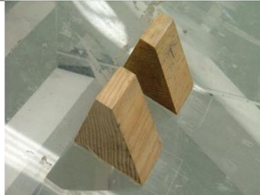
Ilustración 3.24 Colocación de los dados sobre la cubeta de lanzamiento.
