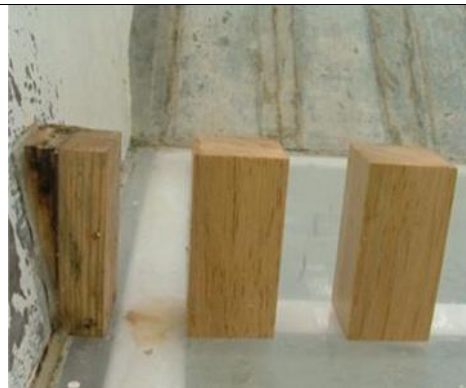
Ilustración 3.26 Colocación de piezas 3*, y 4*, la piezas 3 la mitad del ancho de la pieza 4.
