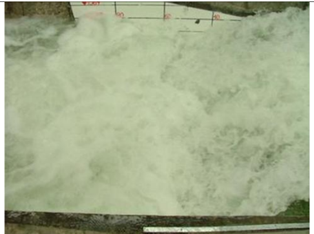
Ilustración 3.47 Alcance del chorro de agua con el gasto de diseño, entre 40m y 60 m
