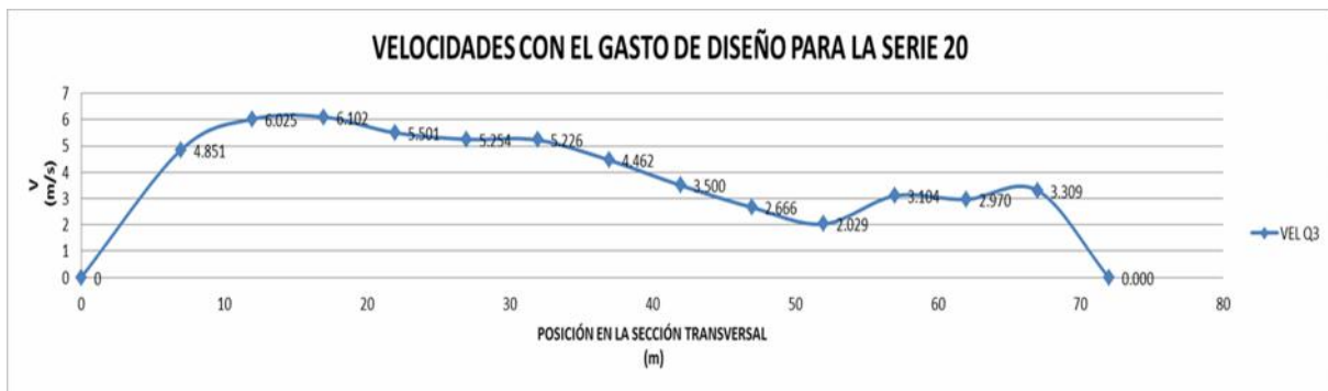
Ilustración 3.65 Gráfica de velocidades para el gasto de diseño 4,795 \text{ m}^3/\text{s}
