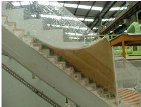
Ilustración 3.28 Colocación de pieza 5* sobre las paredes laterales del canal.
