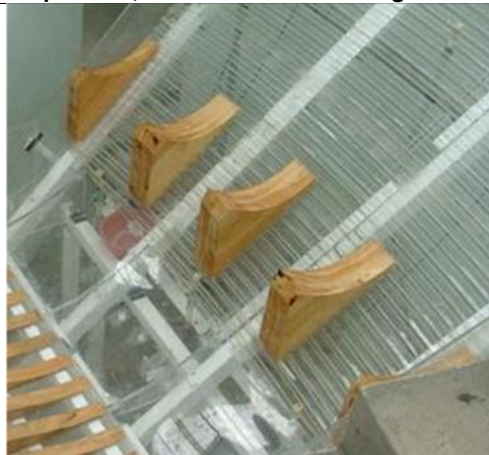
Ilustración 3.29 Deflectores sobre escalones de la rápida, pieza 6*.
