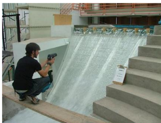
Ilustración 3.41 Medición sobre la rápida
