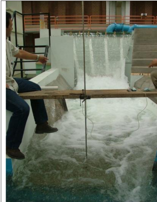
Ilustración 3.35 Sección de medición de velocidades
