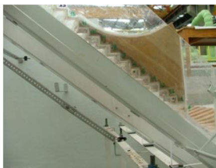
Ilustración 3.19 Vista de perfil de la rápida del modelo físico del vertedor de la presa el Zapotillo.
