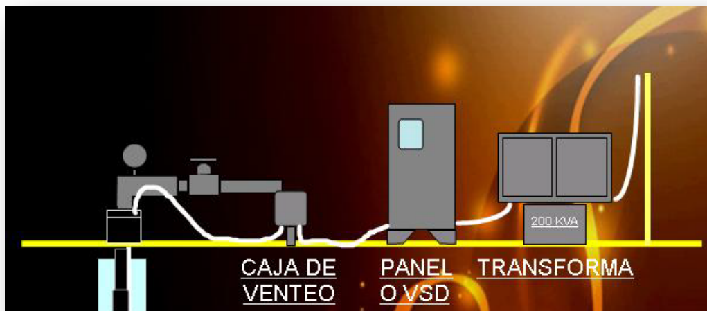
Figura 48. Equipo Superficial BEC
