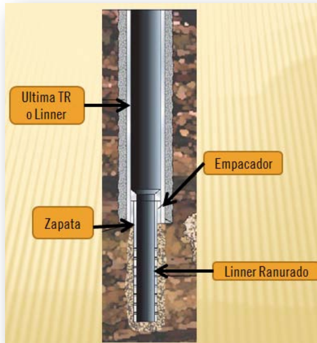
Figura 15. Terminación en tubería ranurada
