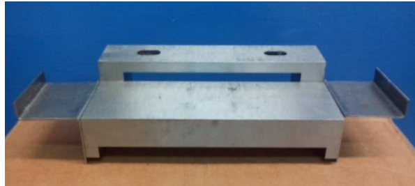
Figura 3.14 Ensamble de los soportes diseñados.
