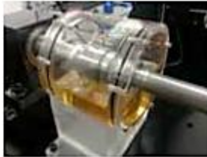
Figura 7.2 Contacto anillo sobre bloque lubricado en MFT. 47
