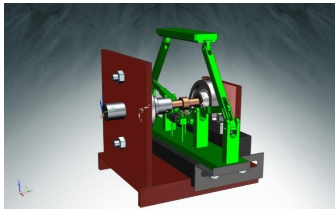
Figura 3.12 Representación de una sección del tribómetro, prototipo de mecanismo para aplicación de carga y aditamentos en posición de operación.
