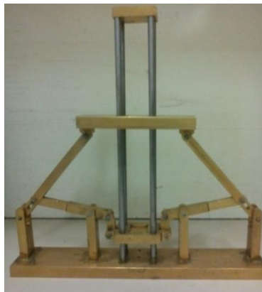
Figura 3.2 Mecanismo para contacto cilindro sobre bloque. 13
