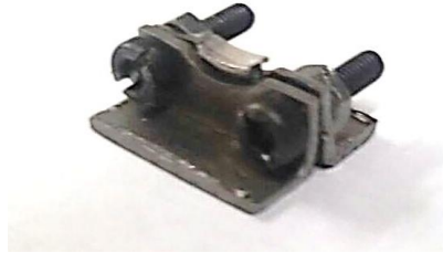
Figura 3.18 Prensa sujetando una muestra.
