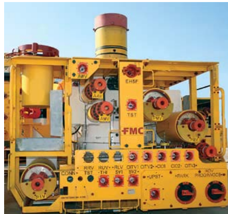
Figura 2.14. Árbol horizontal mejorado EHXT propiedad de FMC 23
