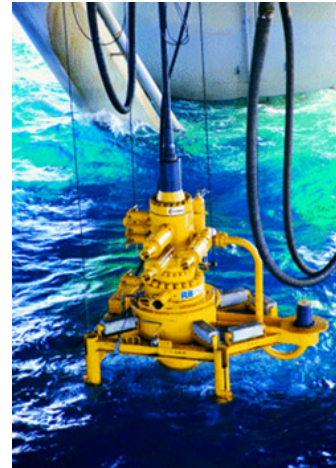
Figura 2.16. Árbol submarino con líneas guía y sin asistencia de buzos ( guideline diverless )
