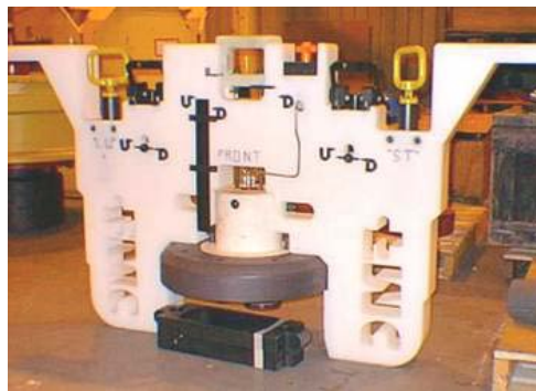
Figura 2.20. Tapa de un árbol vertical mejorado propiedad de FMC 2
