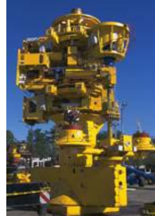
Figura 2.17. Árbol submarino sin líneas guía y sin asistencia de buzos ( guideline diverless ) 2
