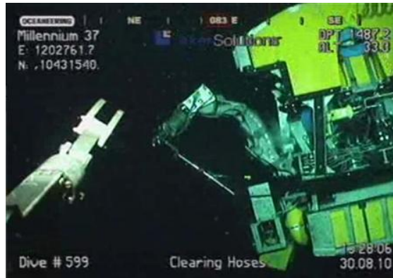
Figura 1.17. Vehículo operado a control remoto (ROV) cerca del sitio del pozo Macondo en el Golfo de México 2010, gran importancia de tener equipos confiables de intervención
