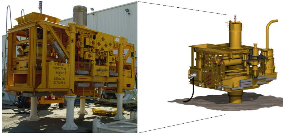
Figura 2.10. Estructura de un árbol horizontal propiedad de Cameron 17
