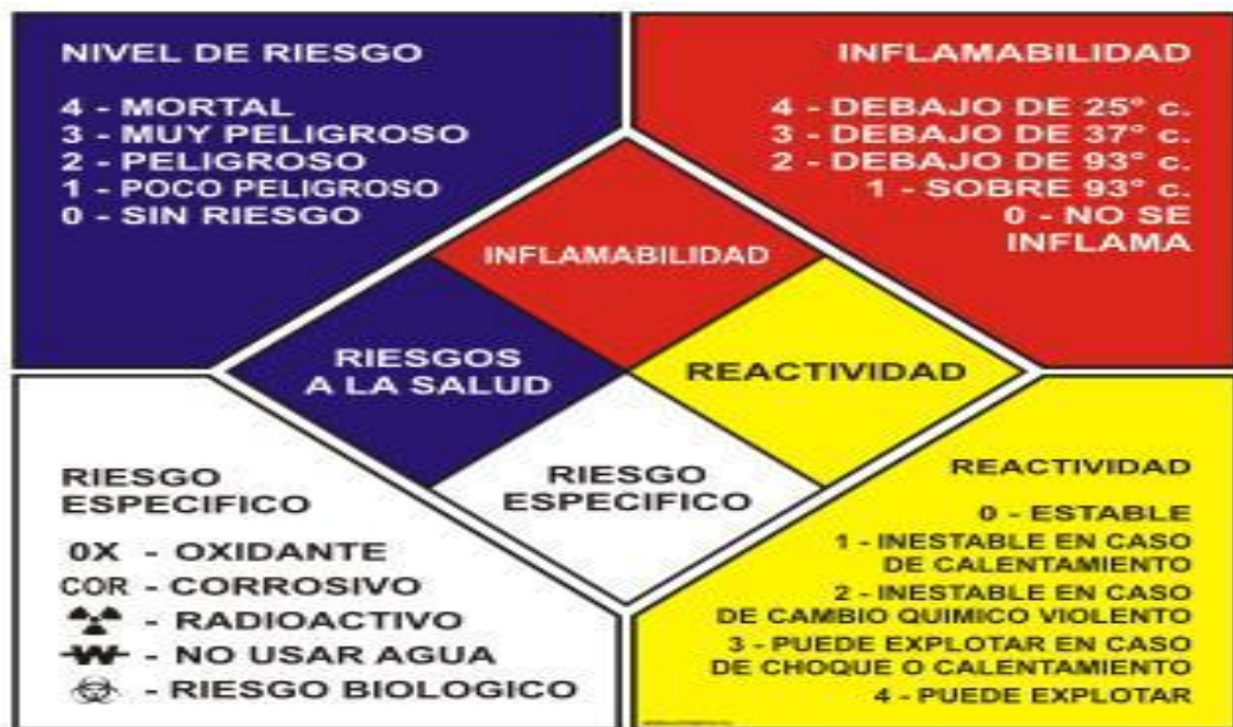
Figura 69. Rombo de señalización de Riesgos.
