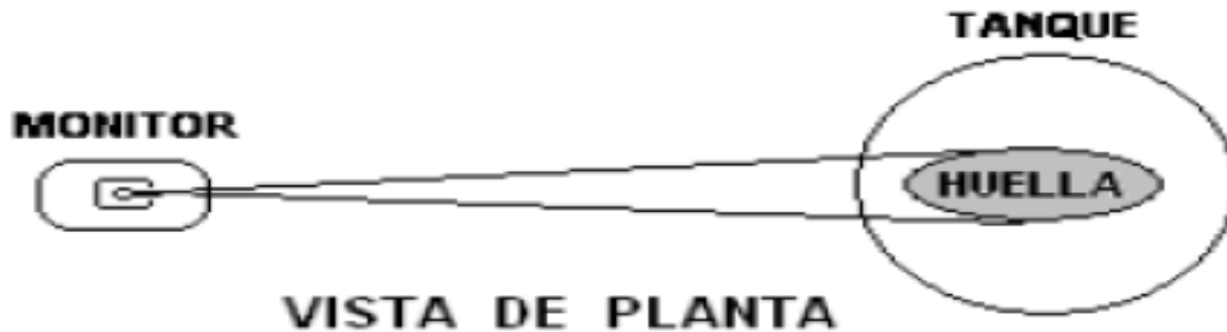
Figura 51. Aplicación de Espuma Tipo III. Técnica de Huellas.
