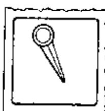
Posición de "DISPARO" (desconexión): Cuando el interruptor dispara automáticamente debido a una sobrecarga o corto-circuito.
