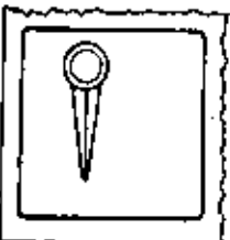
Posición de "DESCONECTADO": La manija queda en esta posición cuando el circuito está "abierto".
