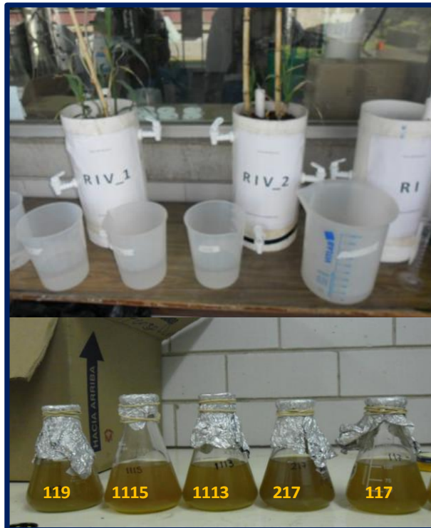
Figura 4.4. Cepas bacterianas utilizadas para inocular los humedales artificiales. Cada porción de caldo nutritivo fue llevada a 800 mL para que en total se tuviera el volumen efectivo de cada sistema (4.0 L)
