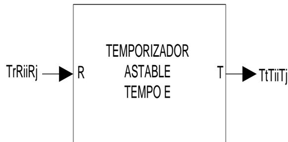
Figura 2.17. Representación genérica de un temporizador astable realizable con el PLM08.
