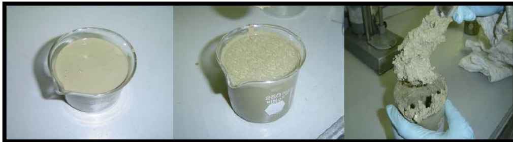
Figura 2.1 Comportamiento del Cemento Ultrafino Emulsionado al contacto con el agua 5
