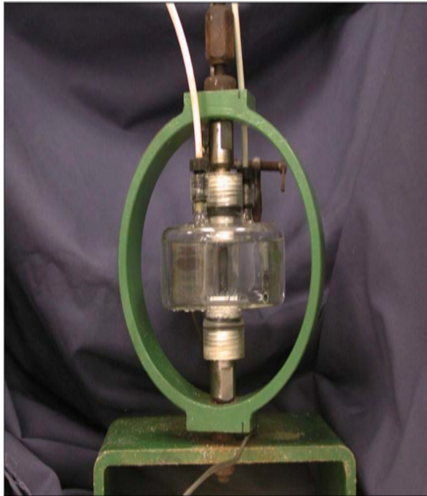
Figura 2 – Cámara de prueba para NACE Método A (Foto cortesía de Honeywell).
