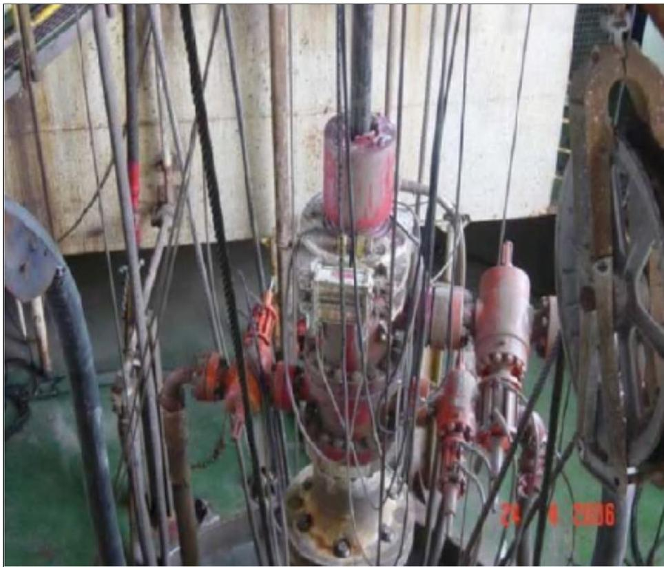
Figura 3.9 RCD submarino<sup>20</sup>.
