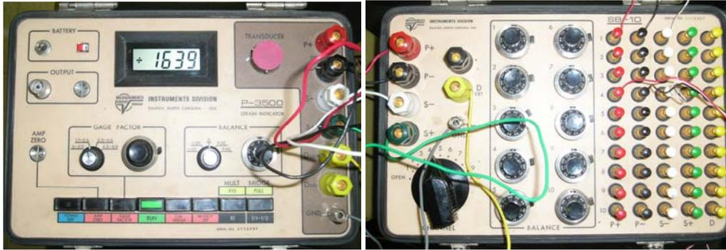
Figura 2.4 equipo de medición de deformación
