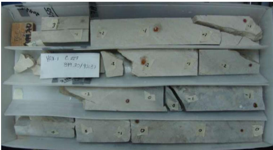
Fig. 3.27. Caja con núcleos cortados, intervalo 899.7-901.8 m.
