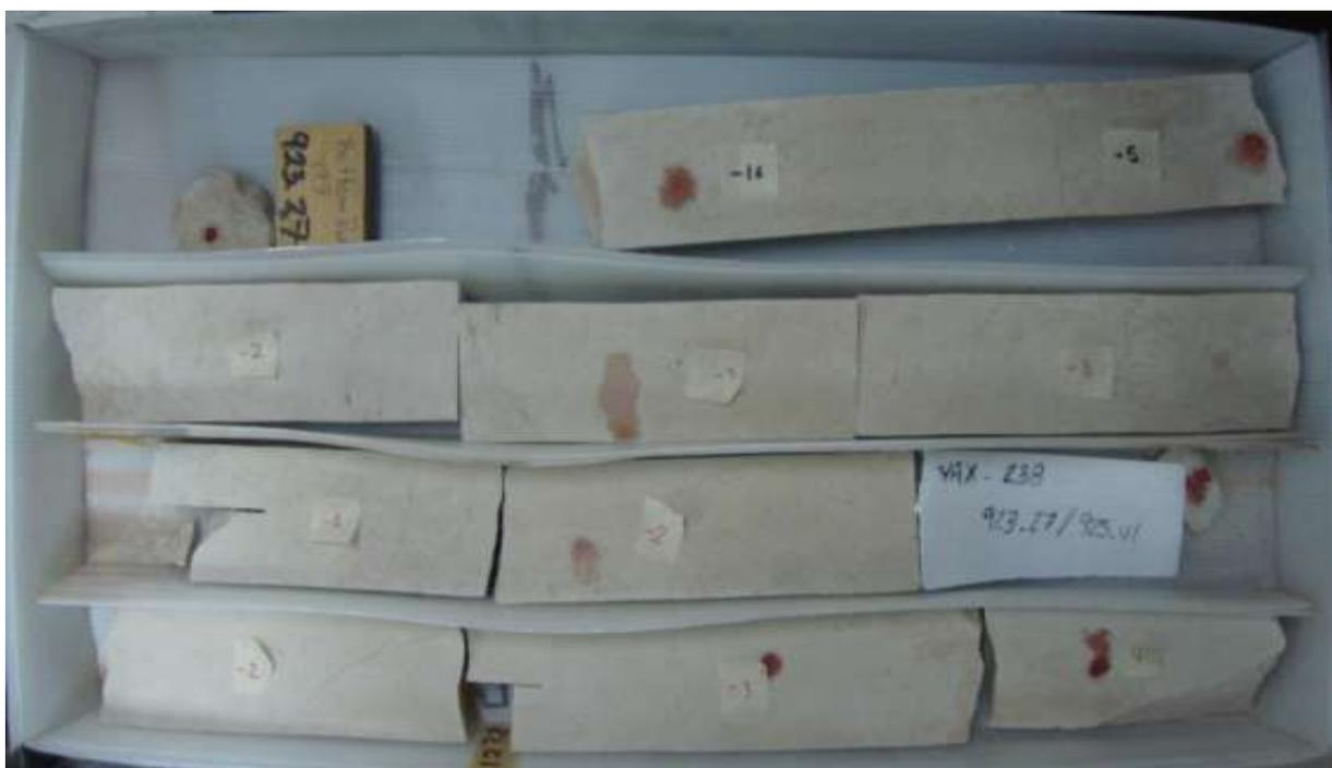
Fig. 3.30. Caja con núcleos cortados, intervalo 923.27-925.41 m.
