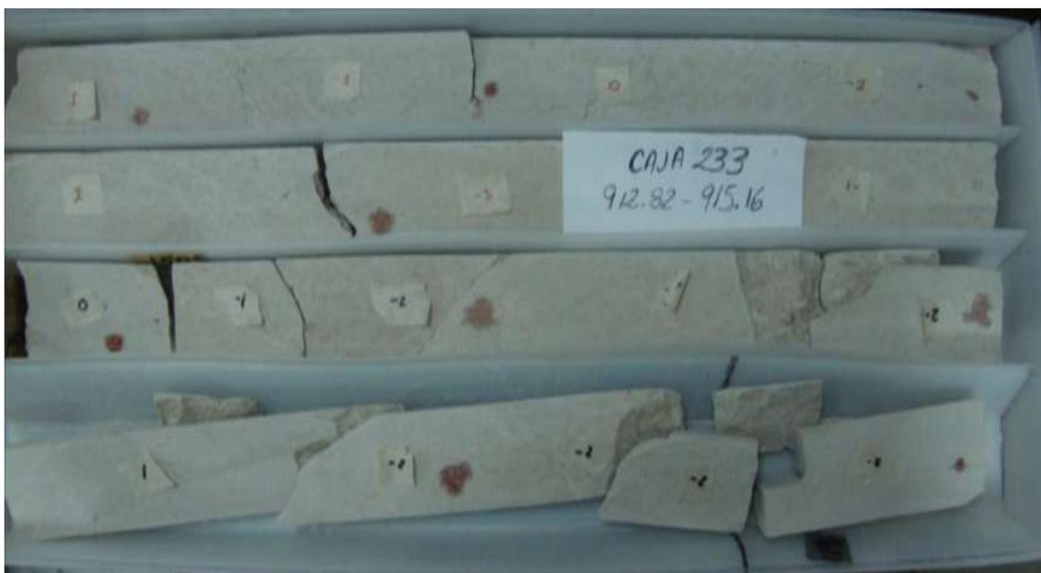
Fig. 3.28. Caja con núcleos cortados, intervalo 912.8-915.1 m.
