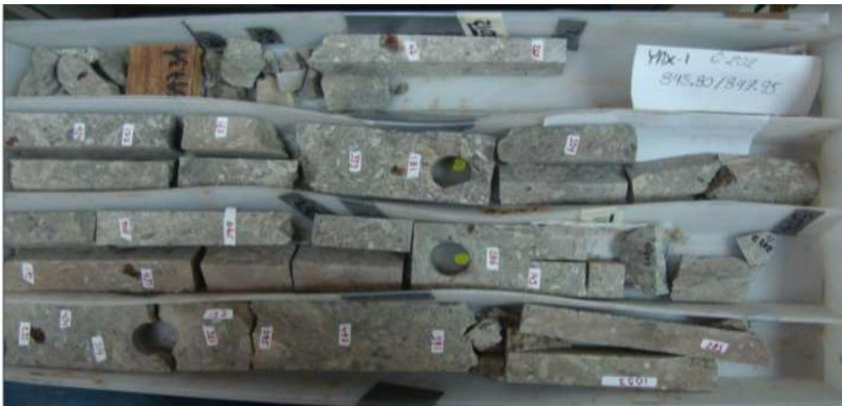
Fig. 3.25. Caja con núcleos cortados, intervalo 845.8-847.9 m.
