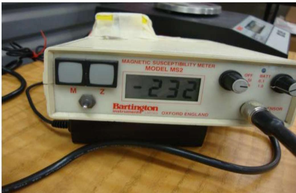
Figura.3.6. Medidor de susceptibilidad magnética.<sup>5</sup>
