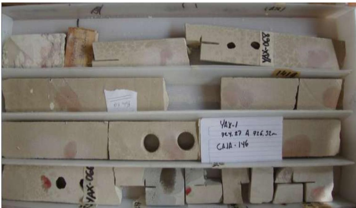
Fig. 3.21. Caja con núcleos cortados, intervalo 724.2-726.5 m.
