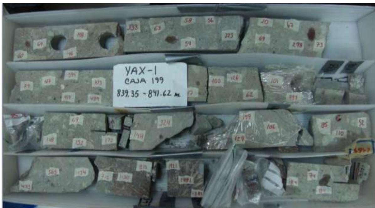
Fig. 3.24. Caja con núcleos cortados, intervalo 839.3-841.6 m.
