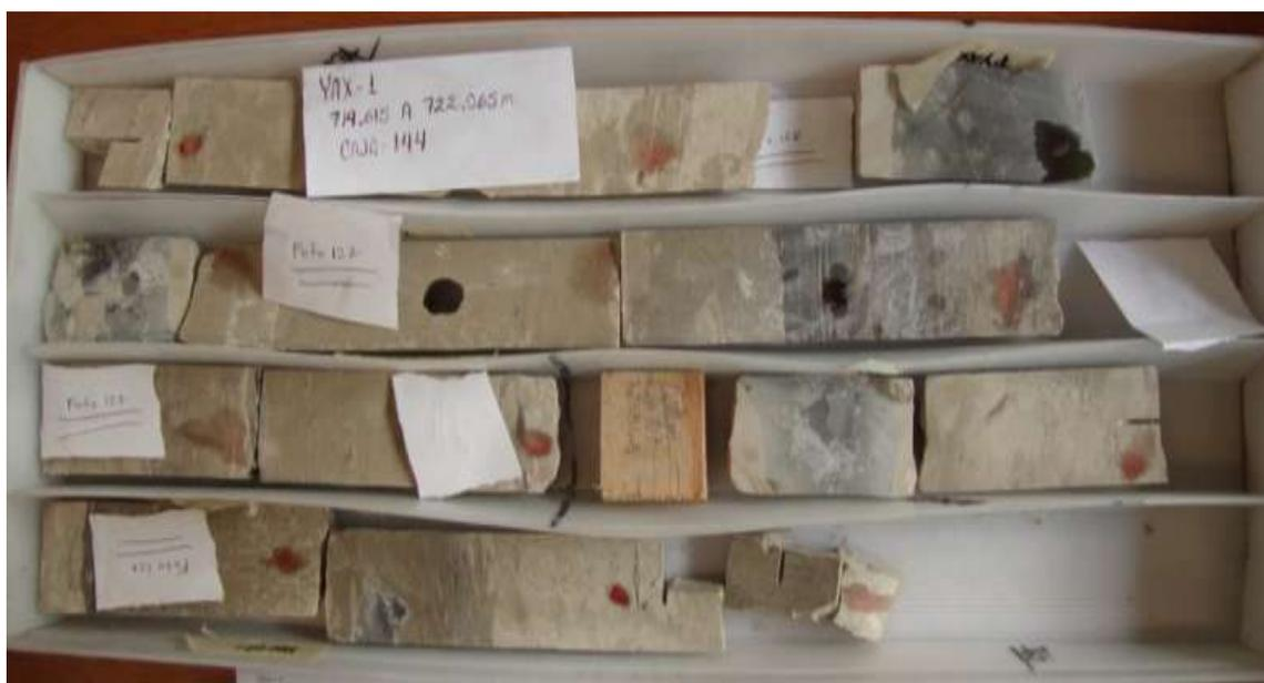
*Fig. 3.20. Caja con núcleos cortados, intervalo 719.6-722.06 m.*
