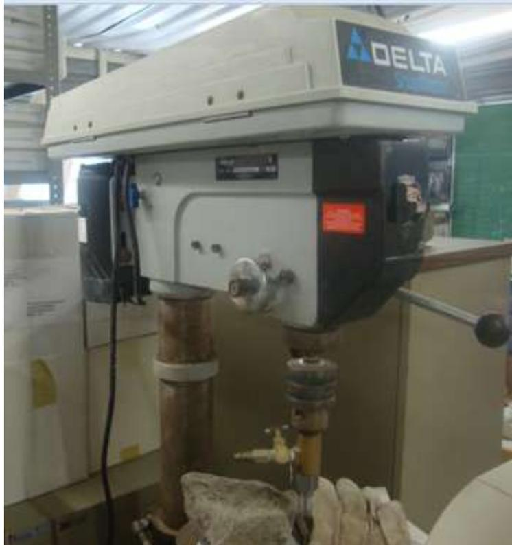
*Fig.3.11 Equipo Especial para extraer muestra de Núcleos.<sup>7</sup>*
