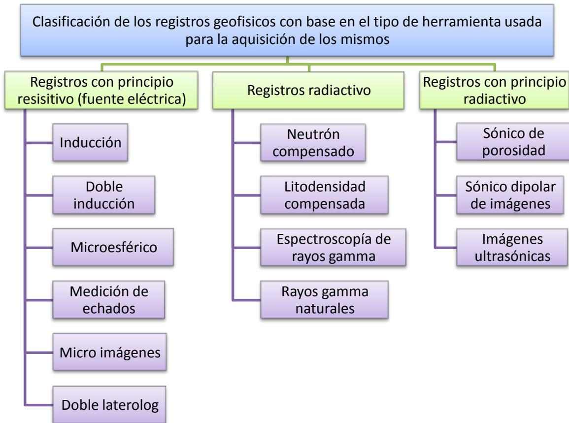
Figura. 1.6. Clasificación de los registros geofísicos con base en el tipo de herramienta usada para la adquisición de datos.
