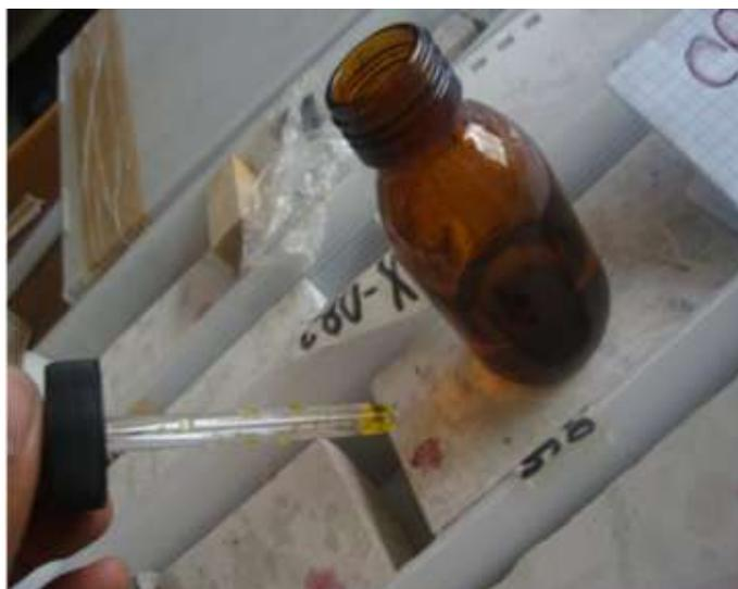
*Fig.3.12. Gotero de Vidrio con Acido Clorhídrico, tomando una muestra de reacción química en un núcleo.<sup>8</sup>*
