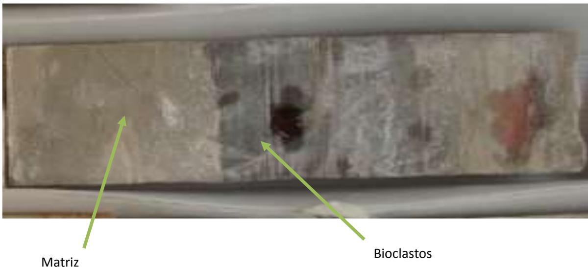
*Fig. 4.3.2 Muestra de Núcleo*
