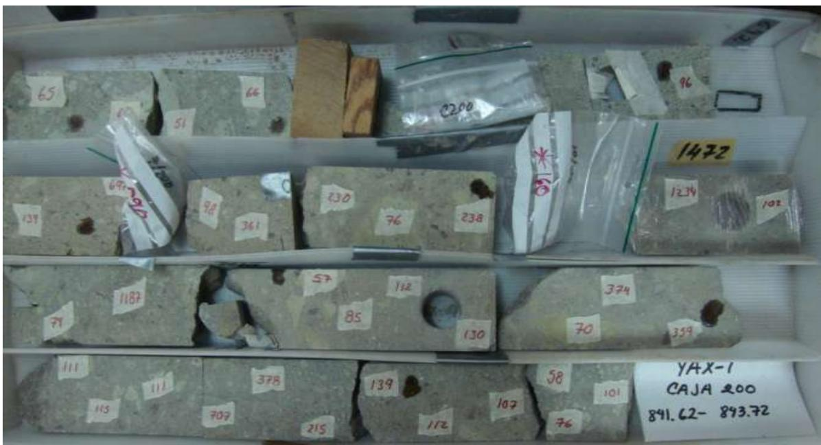
Fig. 3.26. Caja con núcleos cortados, intervalo 841.62-843.72 m.
