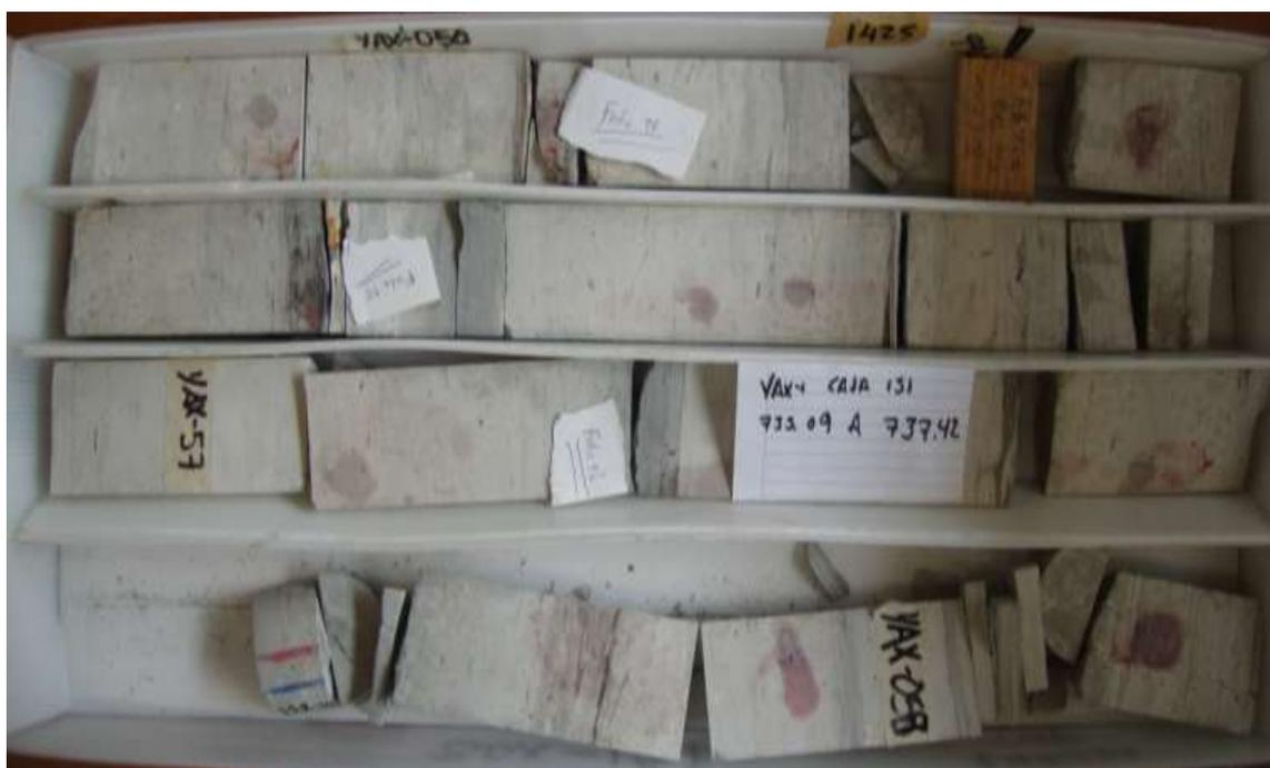
Fig. 3.22. Caja con núcleos cortados, intervalo 706.6-708.89 m.
