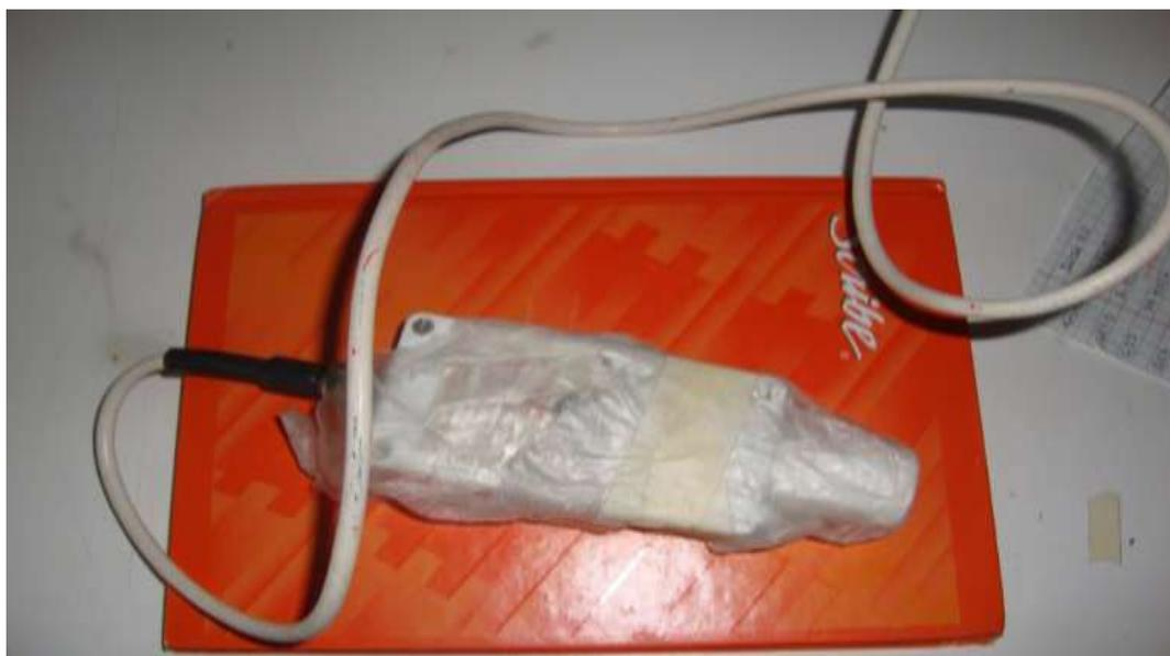
Figura.3.7. Sensor utilizado en la medición de la susceptibilidad magnética de núcleo.<sup>5</sup>
