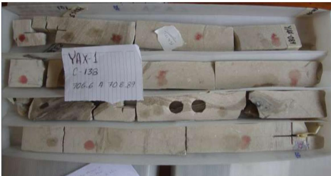
*Fig. 3.19. Caja con núcleos cortados, intervalo 706.6-708.89 m.*
