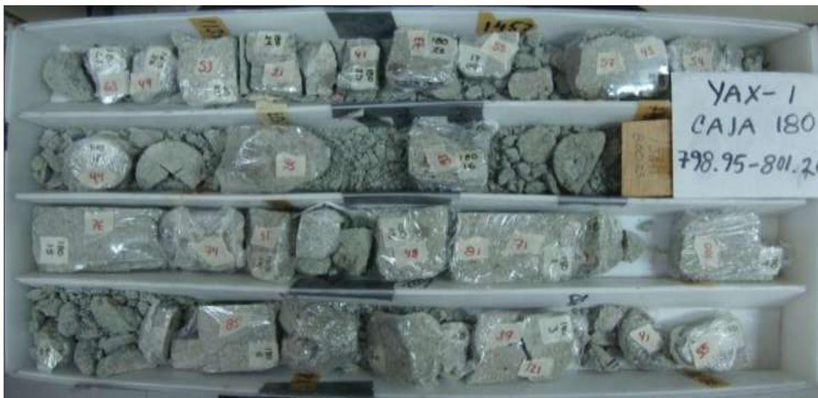
Fig. 3.23. Caja con núcleos cortados, intervalo 798.9-801.2 m.
