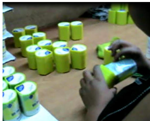
Fotografía A 12: Colocación de la manga
