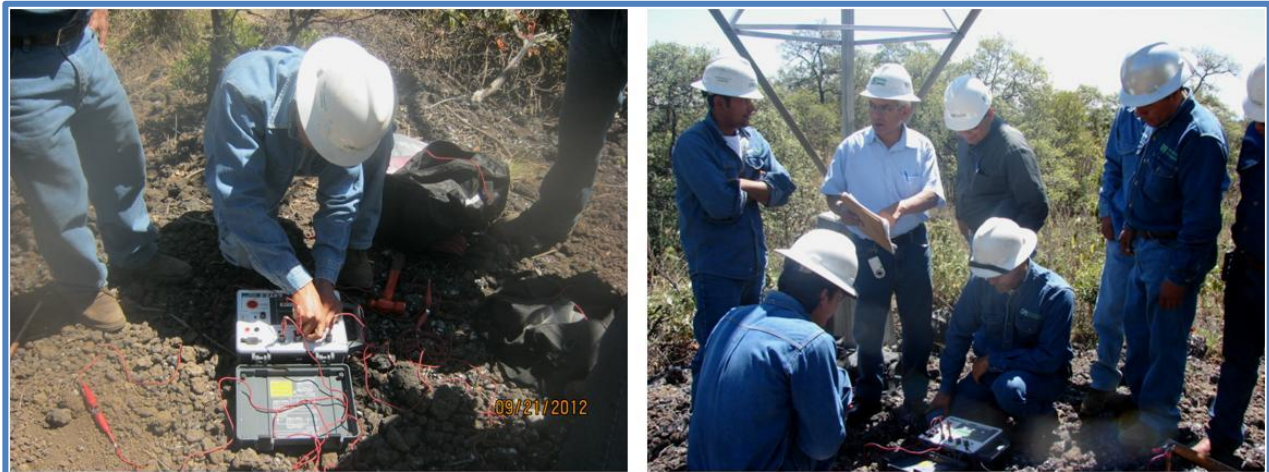
Figura 4.1.3.1-2 Verificación de calibración del equipo de medición
