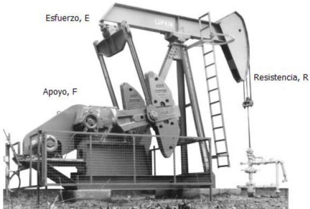
Figura 1.1. Unidad de bombeo mecánico convencional.
