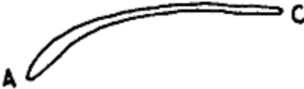
Figura 2.13. Carta dinamométrica que representa Candado de Gas.
