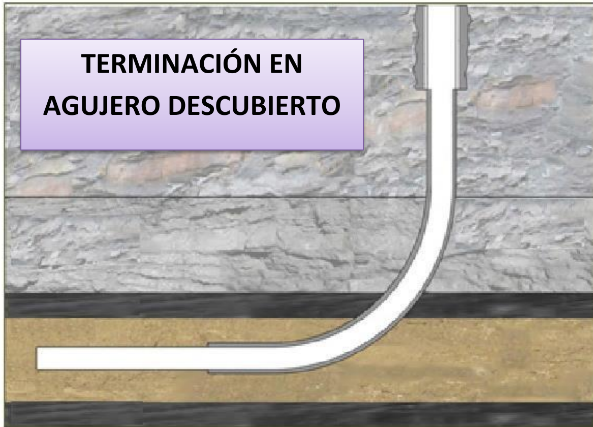
○ Figura 3.3 Diagrama de un pozo horizontal terminado en agujero descubierto.
