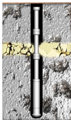
Fig. 2. 17 Hinchamiento de arcillas
