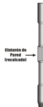
Fig. 2. 14 Identificación de la tubería pesada (recalcado)
