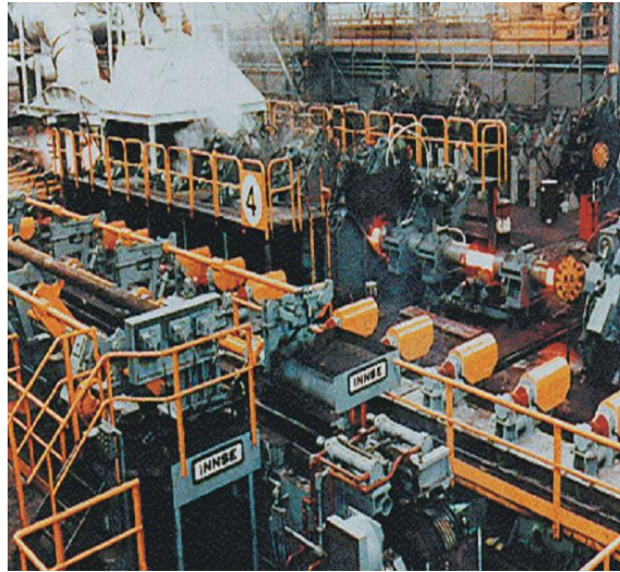
Fig. 3. 5 Laminado continuo a mandril retenido.
