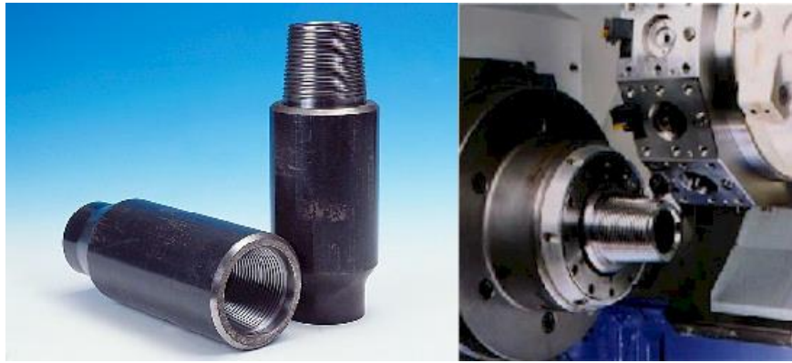
Fig. 3. 14 En la izquierda se muestra un una caja con su respectivo piñón. En la derecha, el maquinado de un piñón.
