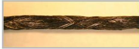
Fig. 15.- Un producto de la nanomanufactura: un cable calibre 16 (arriba) de aproximadamente 1.3 mm de diámetro hecho con nanotubos de carbón hilados. El mismo cable en un carrete de 150 (abajo).
