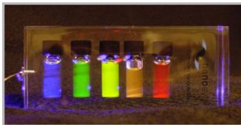
Fig.18.- Puntos Cuánticos: el color fluorescente es determinado por el tamaño de las partículas y el tipo de materiales.
