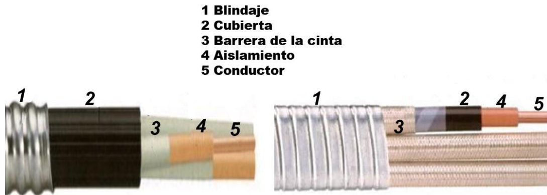
Figura 3.7 Geometrías cable de potencia (Circular y plana)
