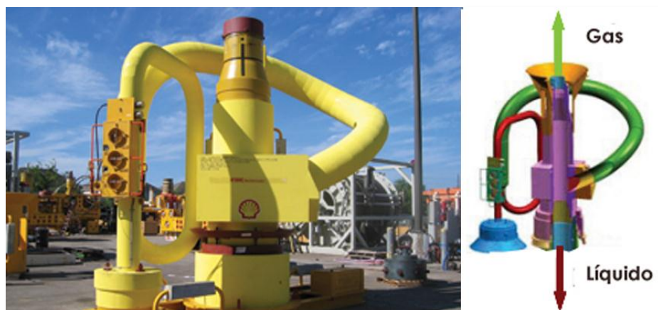
Figura 4.4 Conjunto de entrada utilizada en el CPP
