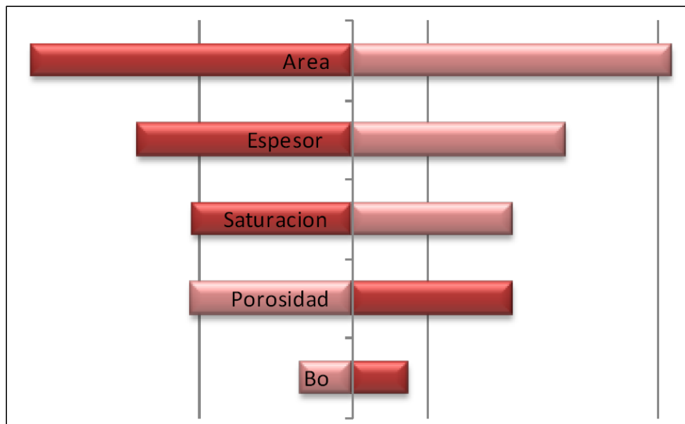
Figura 5.21. Diagrama de Tornado para el Campo Agua Fría (CNH, 2010).
