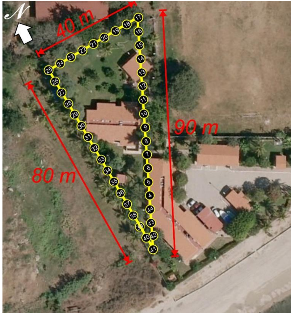
Figura 61. Diagrama del acomodo de electrodos para el arreglo triangular en la Cruz de Huanacastle
