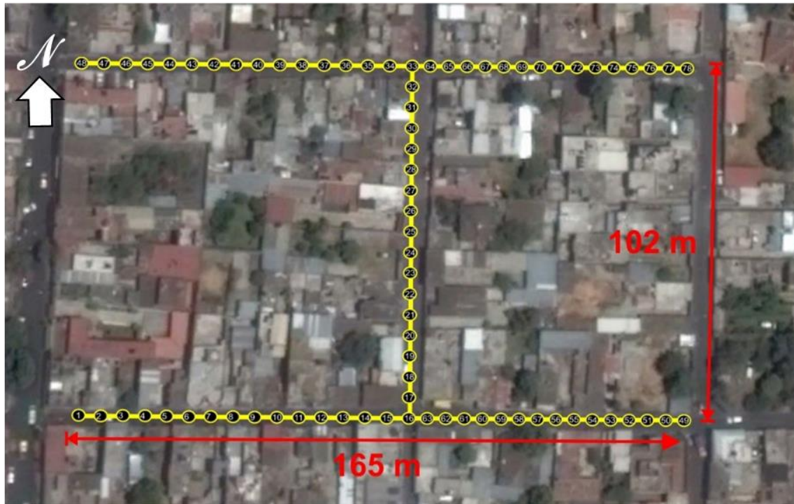
Figura 66. Plano de ubicación del arreglo de Herradura en las calles de San Antonio Tecomitl, Milpa Alta.
