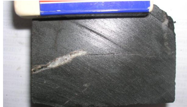
Fractura abierta delgada conectada a una de mayor apertura (C-1A)
