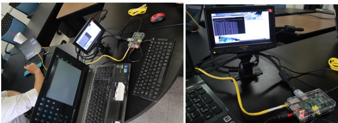
Figura 4.12 a) Conexión Ethernet entre red LAN y el Raspberry Pi (izquierda) transmisión de información entre ambos (derecha)
