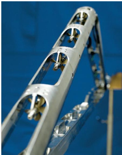
Fig. 1.9 Herramienta utilizada para medir el flujo en pozos horizontales y desviados.
