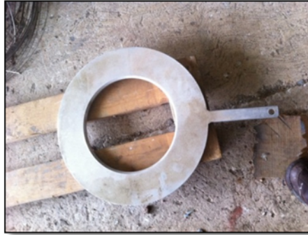
Figura 2.12 Placa orificio para medir flujo de vapor.
