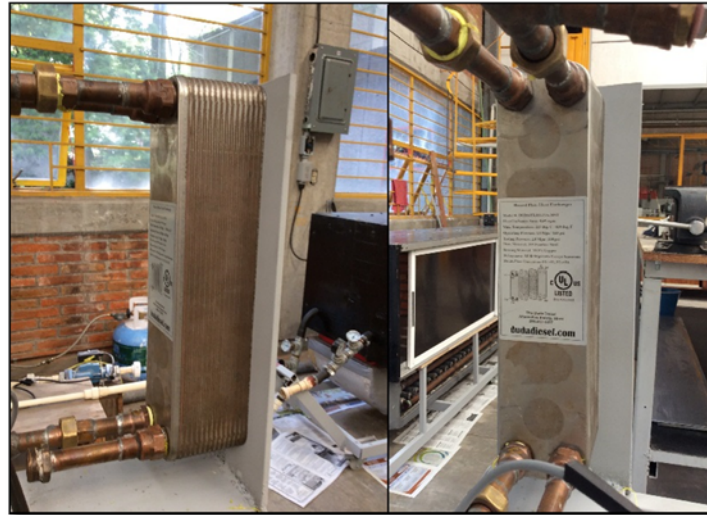
Figura 3.30 Intercambiador de calor de placas marca DudaDiesel.
