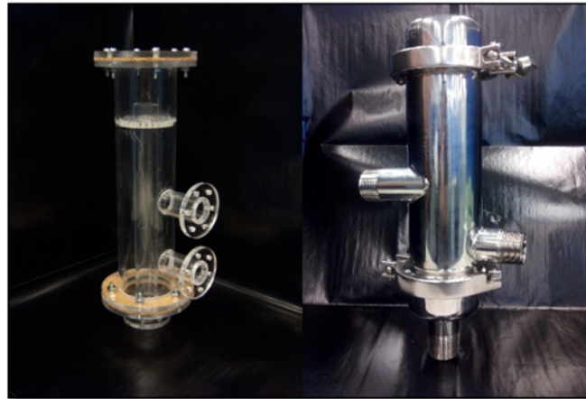
Figura 3.32 Evolución de los modelos del separador de vapor.
