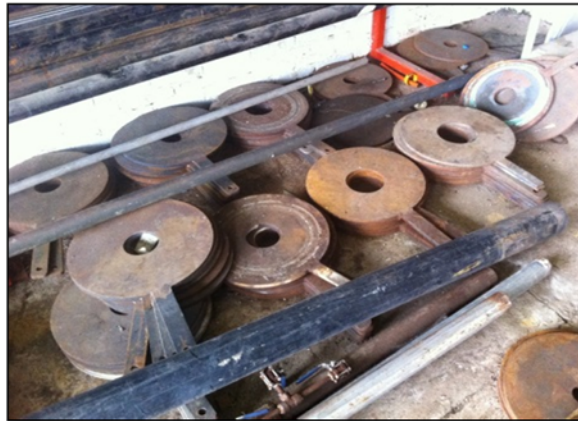
Figura 2.10 Grupo de placas orificio utilizadas en la central geotermoeléctrica Los Azufres.
