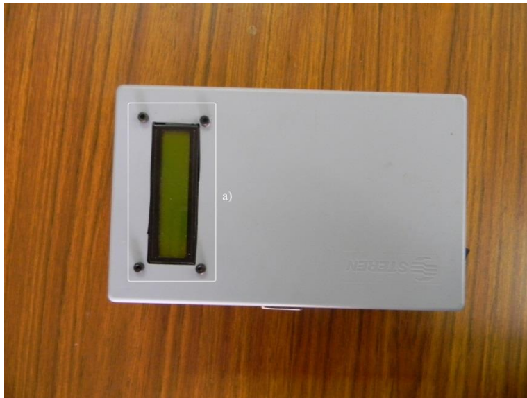
Figura B.8 Vista frontal del gabinete, a) Pantalla LCD.
