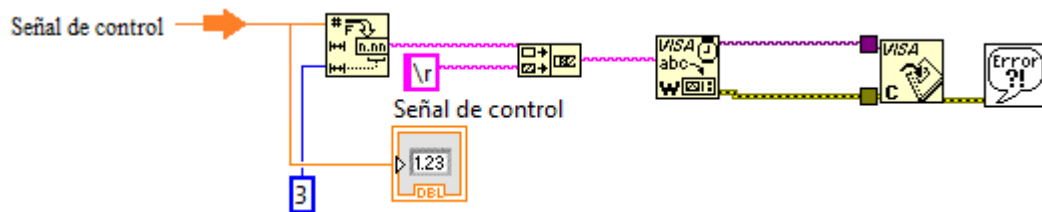
Figura 3.9 Bloque de envío hacia el microcontrolador por medio de los bloques VISA.
