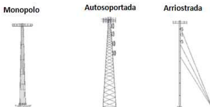
Figura 2.22 Tipos de torres de telecomunicaciones
