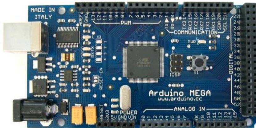
Figura 3.19. Microcontrolador ATmega2560 [14].
