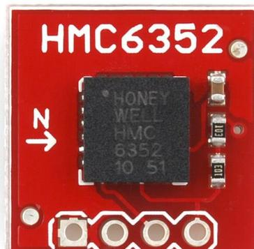
Figura 3.15. Brújula Honeywell modelo HMC6352.
