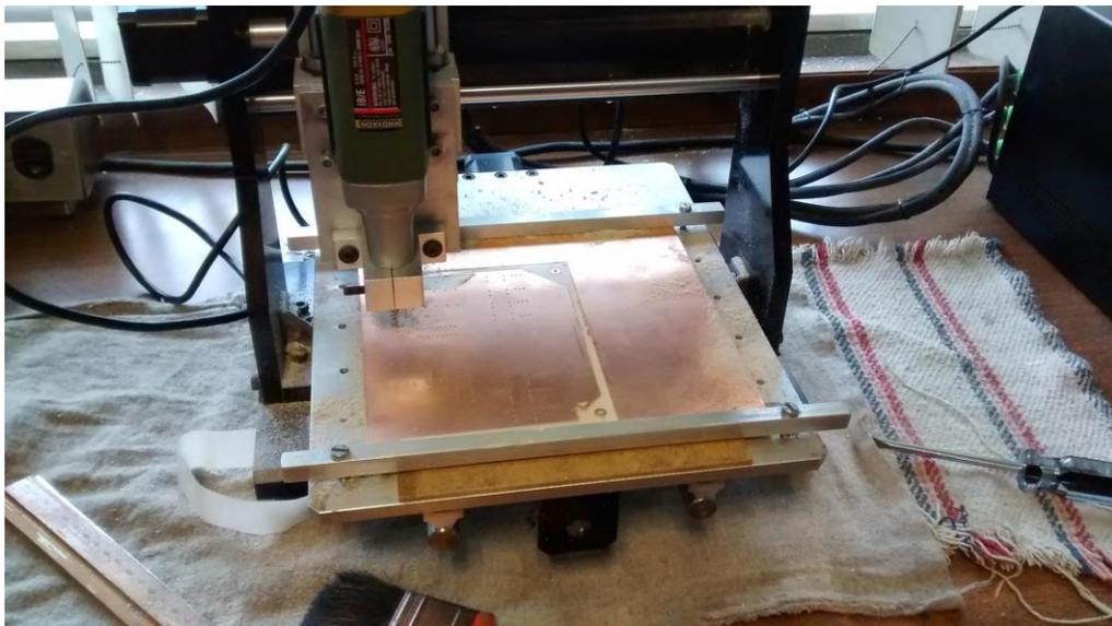
Figura 3.55. Tarjeta electrónica siendo fabricada por el CNC.
