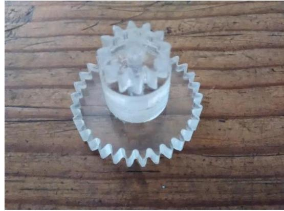
Figura 3.48. Pieza terminada.
