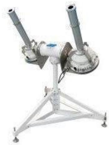
Figura 2.4. Seguidor STR-32G de la empresa Eko Instruments. [2]
