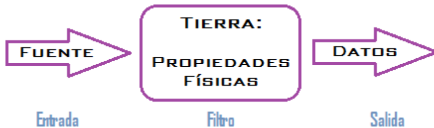
Figura 3.3.1 Sistema básico de los métodos de prospección geofísica.
