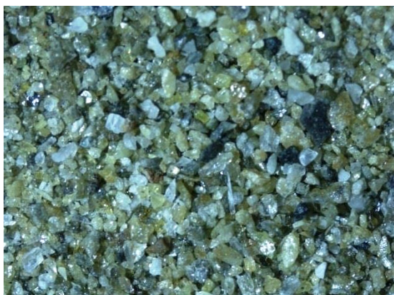
Figura 53. Colas de la prueba 6, sin concentrado magnético a 400x
