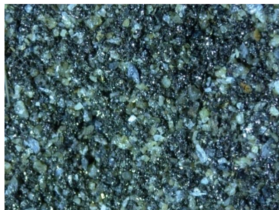
Figura 54. Concentrado magnético, obtenido desde las colas de la prueba 6 a 400x
