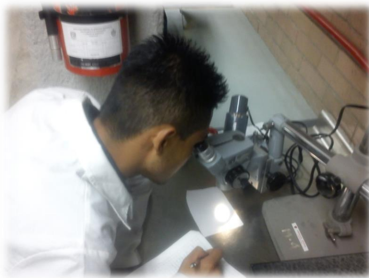
Figura 24. Muestra la observación al microscopio estereoscópico para el conteo de partículas.
