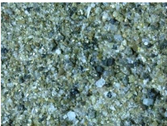
Figura 49. Colas de la prueba 1, sin magnéticos a 400x
