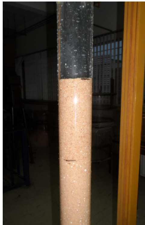
Imágenes 21 y 22. Colocación de arena en filtros delgados
