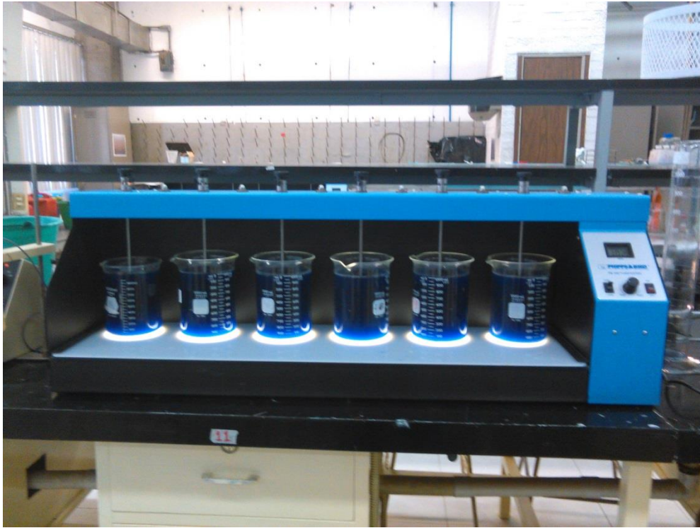
Imagen 42. Ensayo a muestra sintética con colorante textil
