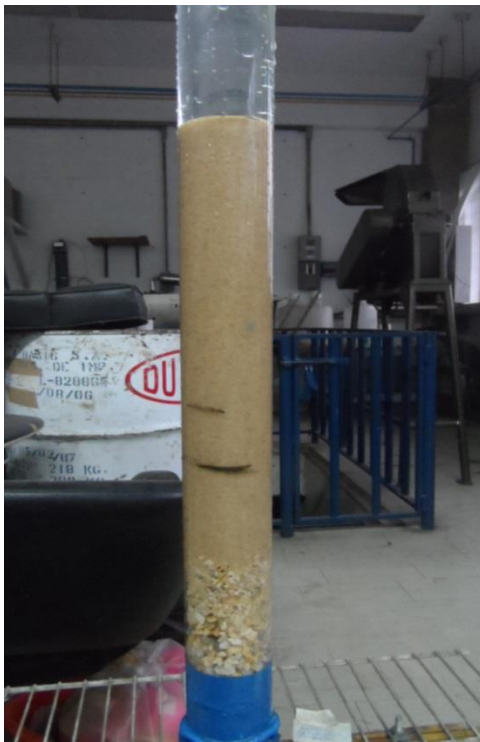
Imágenes 21 y 22. Colocación de arena en filtros delgados
