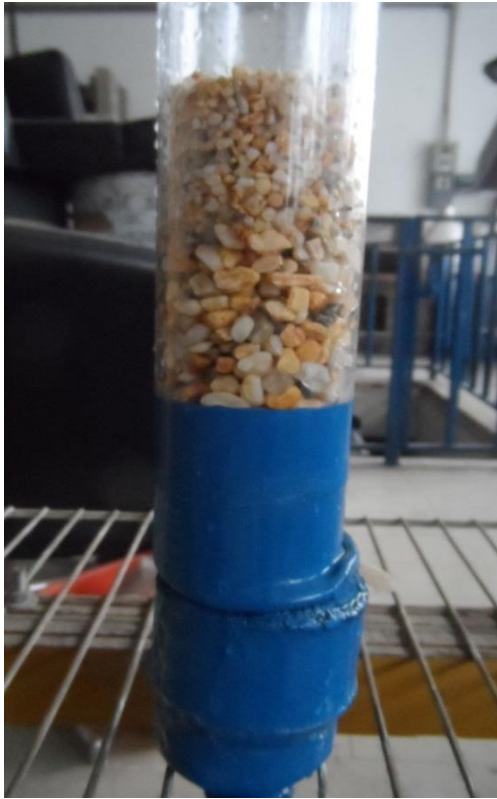
Imágenes 19 y 20. Colocación de arena en filtros delgados
