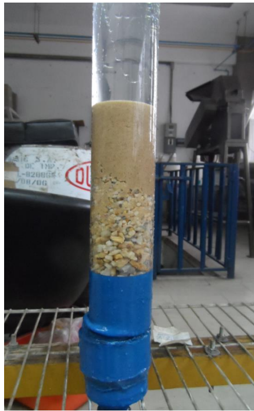
Imágenes 19 y 20. Colocación de arena en filtros delgados
