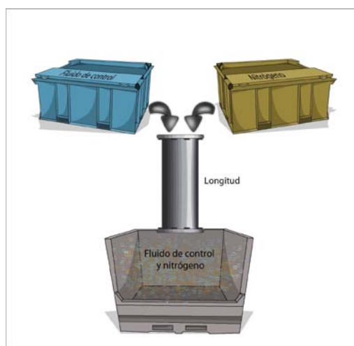
Figura 17 Inyección del fluido de control y gas nitrógeno a través de la tubería de perforación.
