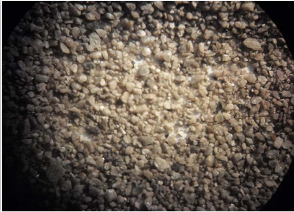
Figura 8 Foto muestra de recortes del pozo Samaria 6092-H, profundidad desarrollada 4595 [m], antes de entrar al yacimiento.
