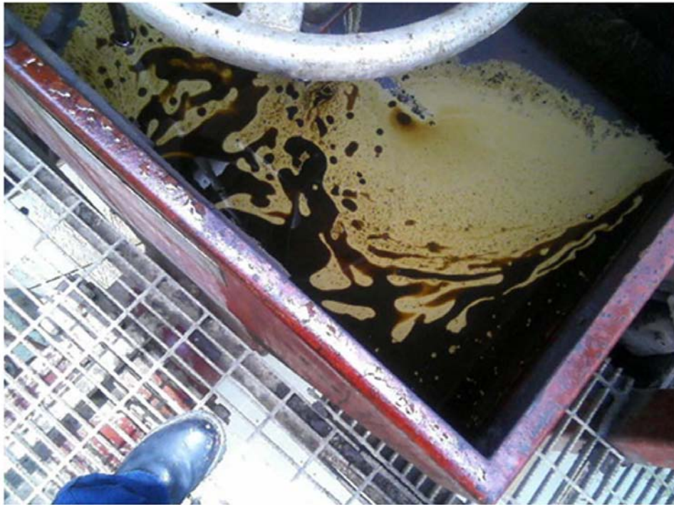
Figura 11 Mezcla de fluido de perforación, gas nitrógeno e hidrocarburos resultado del aporte de la formación.
