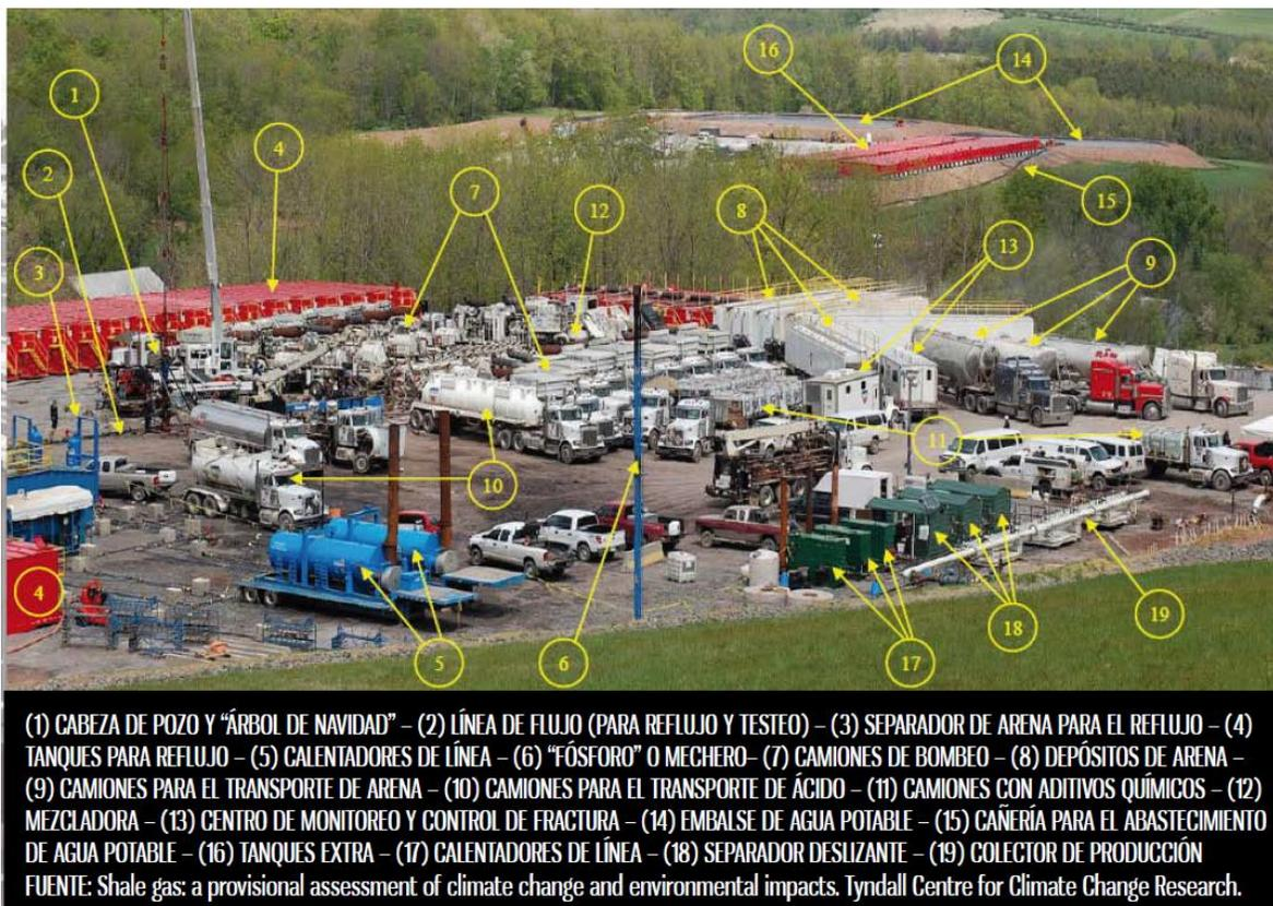
Figura 2.14 Despliegue Territorial Durante un Proceso de Fractura Hidráulica
